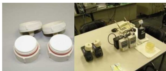
図 1-5-1 MCE フィルター及び測定風景
