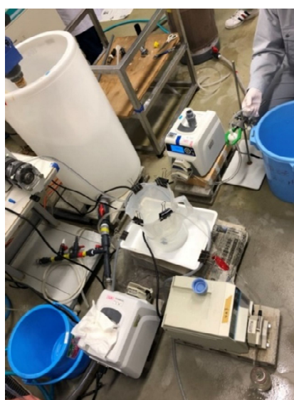
写真 7 小型 UV-LED への連続通水実験
