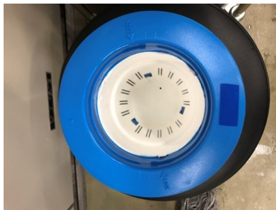
写真2 塩素供給器（浮遊式）内部
