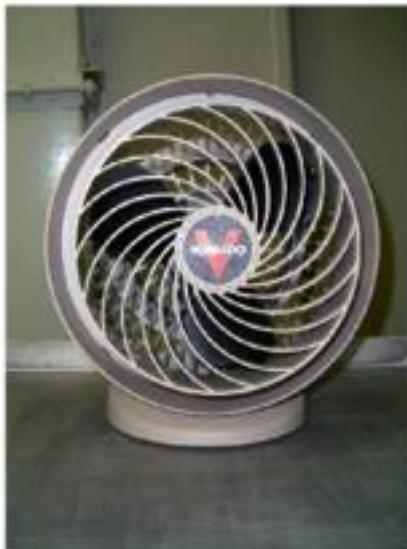
Photo 2 チャンバー内空気攪拌用 サーキュレーター(ボルネード)
