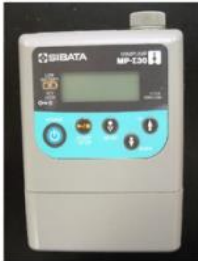
Photo 4 捕集管採気用ポンプ MP \Sigma -30、(柴田科学)
