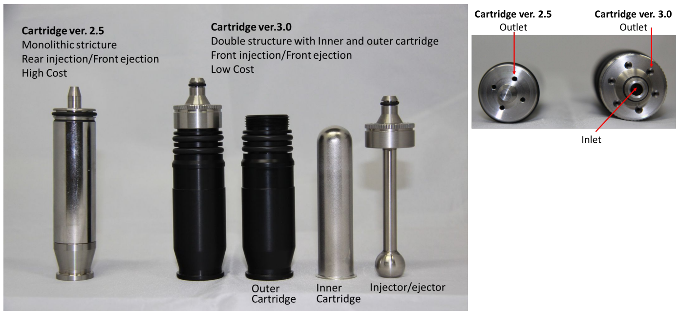
図4 Taquann 直噴全身曝露吸入装置のカートリッジ
