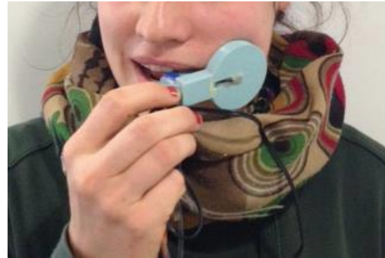
Abbildung 3: In Erprobung - Nichtinvasives Blutdruckmessverfahren an der Wange
