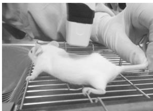
[図 2 ケージトップで牽引保定による背部皮膚温度測定 (FS-700)]
