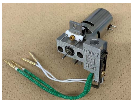
図1 GC/MS イオン源(本研究で用いた Agilent Technologies 社製のもの)
