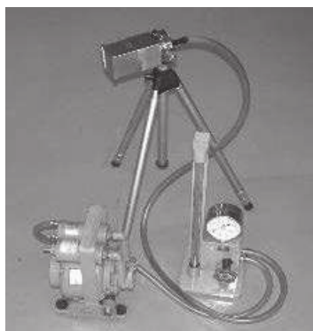
試料採取器（サンプラー及びポンプ） 相対濃度計（デジタル粉じん計）
