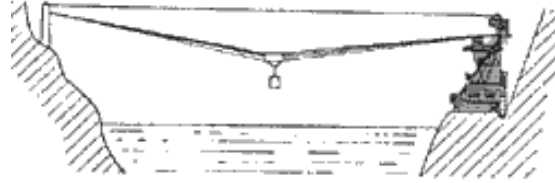
図 15 片側走行ケーブルクレーン
