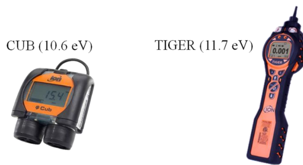
図3 測定に用いたリアルタイムモニタ
