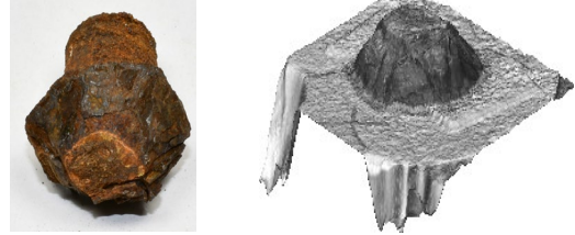
図3 現地調査で収集した減肉ねじ部品のサンプル(左)と3DデータによるDEM表示(右)(採取位置：下1ボルト)
