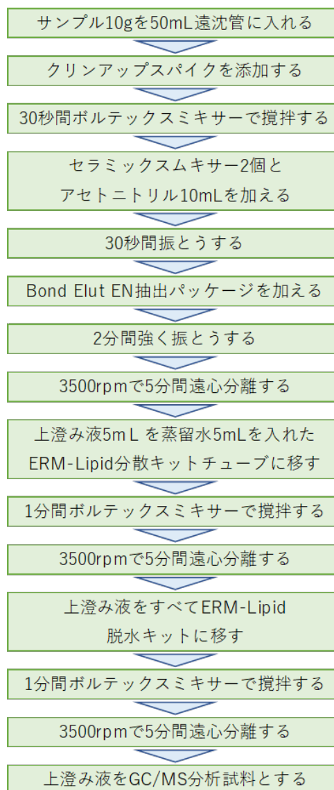
図 1. QuEchERS法によるホタテガイに残留する有機塩素系農薬及び PAH類の分析手順
