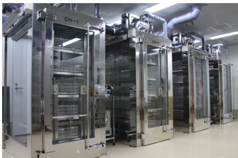
Photo 1 3\text{m}^3 横層流大型チャンバー及びその発生装置(柴田科学)
