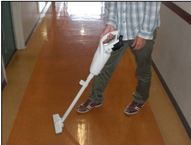
Figure 2 ハンディー掃除機を用いた ハウスダスト捕集
