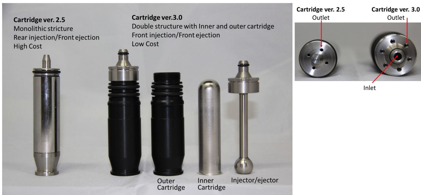
図4 Taquann 直噴全身曝露吸入装置のカートリッジ
