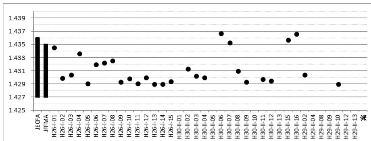
■□:規格、◆◇:規格(幅なし)、●○:実測値、それぞれ黒塗りは n<sub>D</sub><sup>20</sup>、白抜きは n<sub>D</sub><sup>25</sup>
