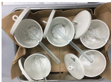
予備灰化及び乾式灰化を3回繰り返した後の様子
