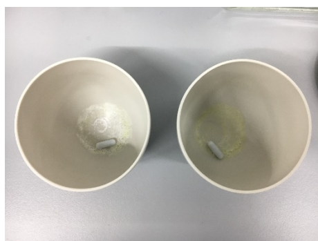
Fig.4 食用赤色3号の灰化後の様子（タール色素試験法ヒ素試験法）
