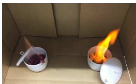
硝酸マグネシウム・エタノール溶液に点火した様子
