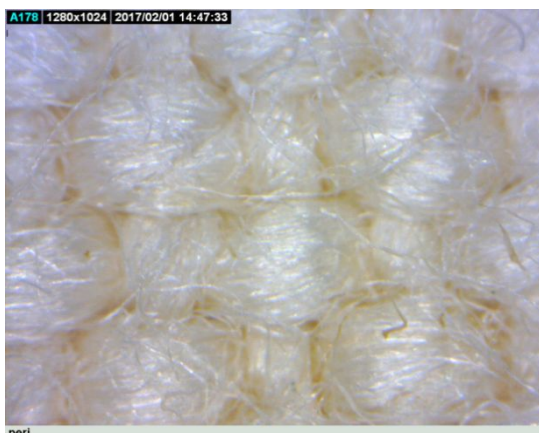
(左)新品 (右)石灰粉堆積(中間2月22日) 黒い部分はろ布に引いた油性ペンの線
