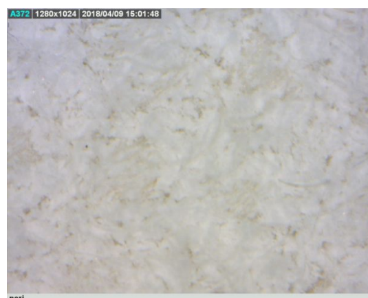
最終の石灰粉堆積状態、(左)吸引口と反対側のろ布表面 (右)吸引口側のろ布表面
