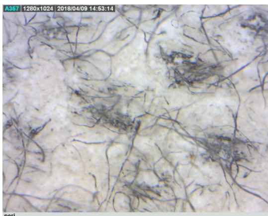
最終の石灰粉堆積状態、(左)吸引口と反対側のろ布表面 (右)吸引口側のろ布表面
