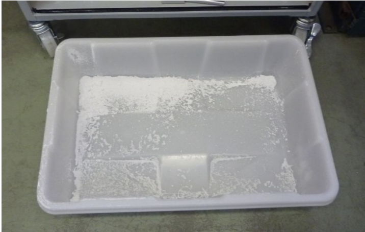
図4 - 2 3 払落し直後のダストバケットの石灰粉 画面上方左が粉じん吸引口近く、画面下が取り外し蓋側
