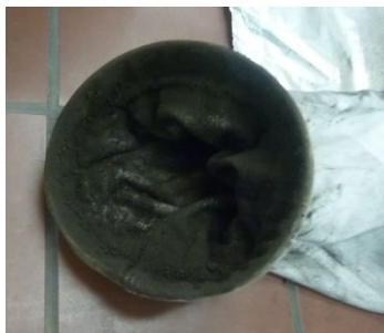
図3 - 24 集じんろ布に捕集されていた粒子の観察 溶接ヒュームを主とした粒子
