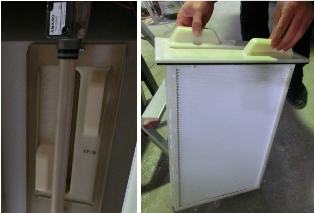
図2 - 7 フィルタの状態 左 装てん状態、 右 取り外した状態 本試験装置（アマノ PiF30）は4ユニットのフィルタが装てんされている。（広島大学）
