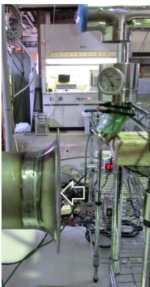
図 2 - 5 パルスジェット式除じん装置（アマノ PiF30）の性能評価のための粉体分散方法（広島大学）
