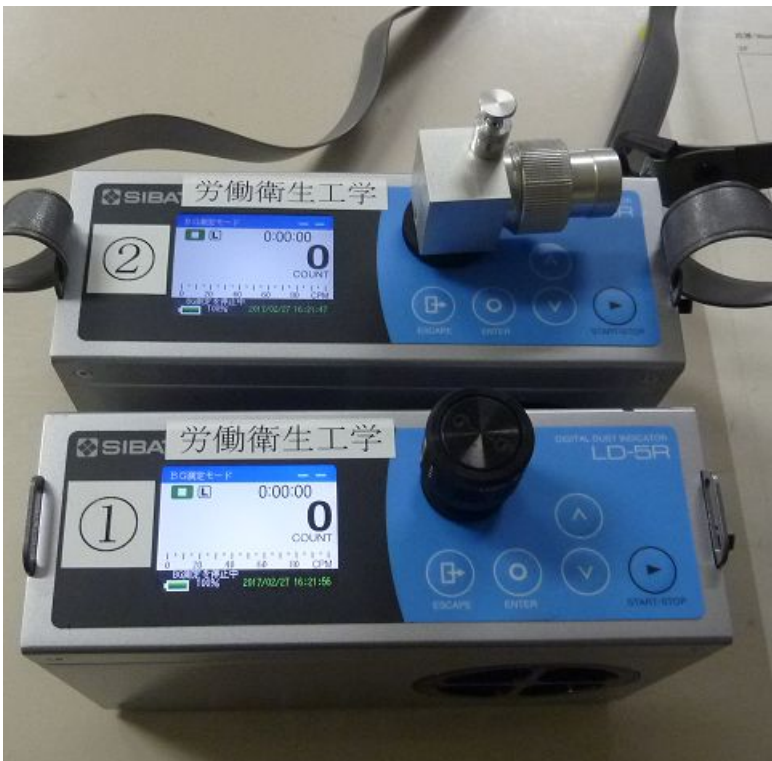
図3 - 3 PM2.5 サイクロンを取り付けたLD - 5 R (上) 通常の柴田科学 LD - 5 R (下)
