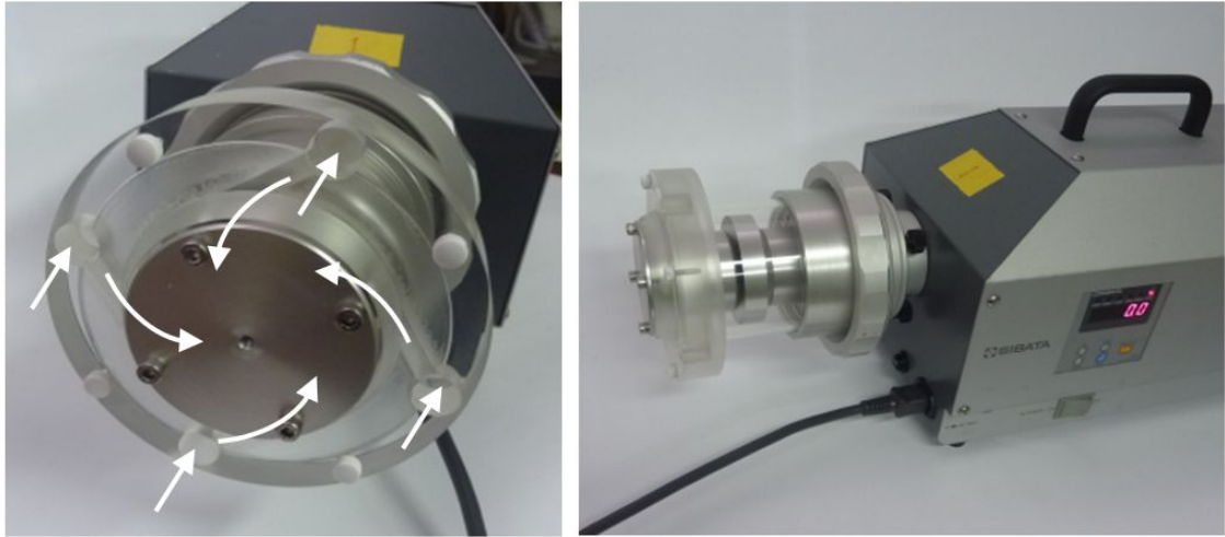
図3 - 7 ハイボリウムエアサンプラ用のサイクロン 左の図の白の矢印はサンプリング気流の方向を示している。
