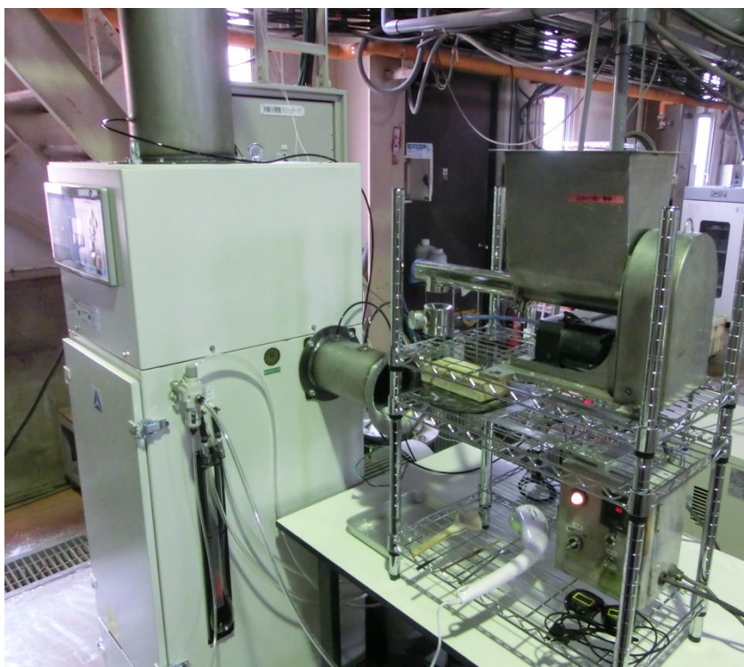
図2-6 パルスジェット式除じん装置の装置構成（広島大学） 左側がパルスジェット式除じん装置で右側が粉じん供給装置 出口濃度は上部（2階部）に設置してある粉じん計によっている。
