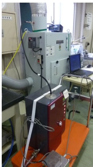
図 3 - 8 電氣的低圧インパクト（ELPI）の分離粒径と外観（手前の台車上）
