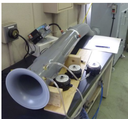
図 3 - 1 3 入口のベルマウスと圧力タップ
