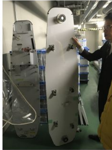
図3 ドクターヘリ用に開発した新生児搬送ユニット。ドクターヘリストレッチャーに固定して使用する。
