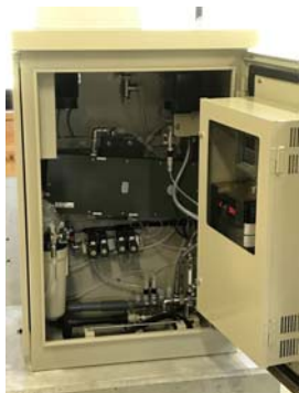
自動水質監視装置
