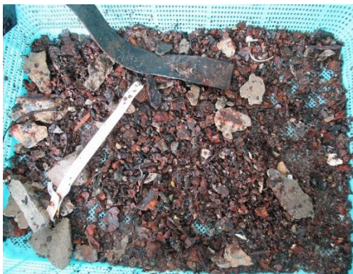
F) B 配水池堆積物
