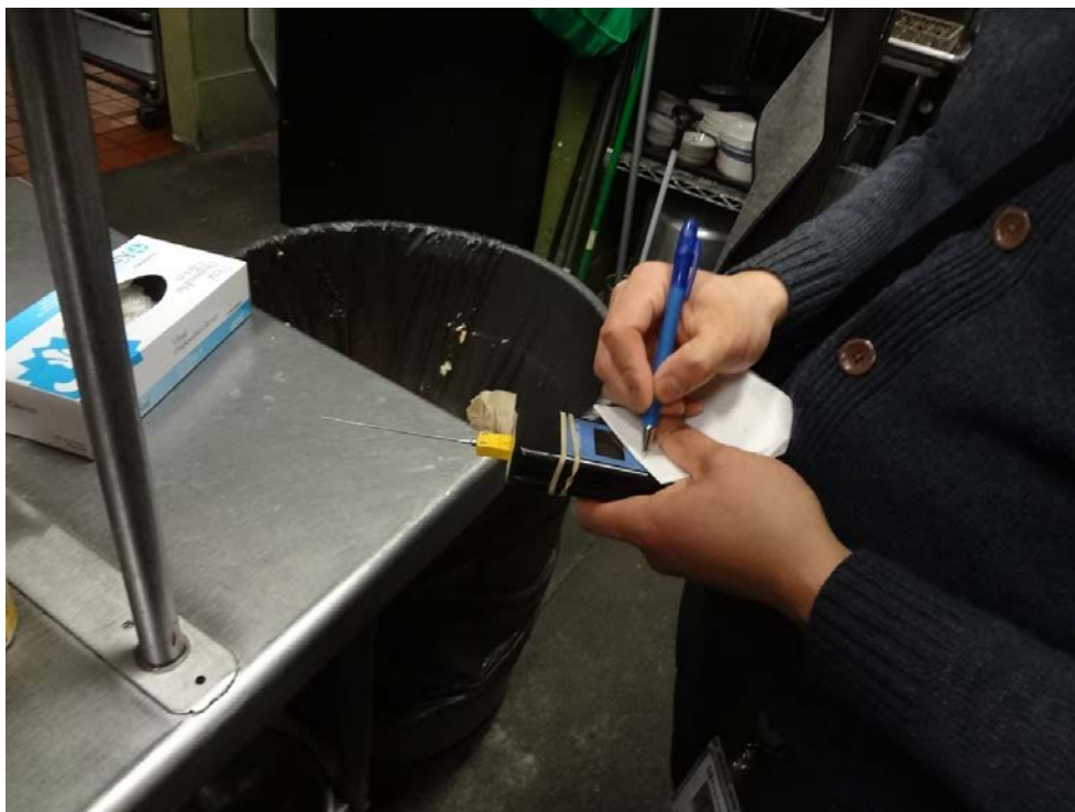
写真7：プローブが長い中心温度計であらゆる食材の温度を測定し記録する
