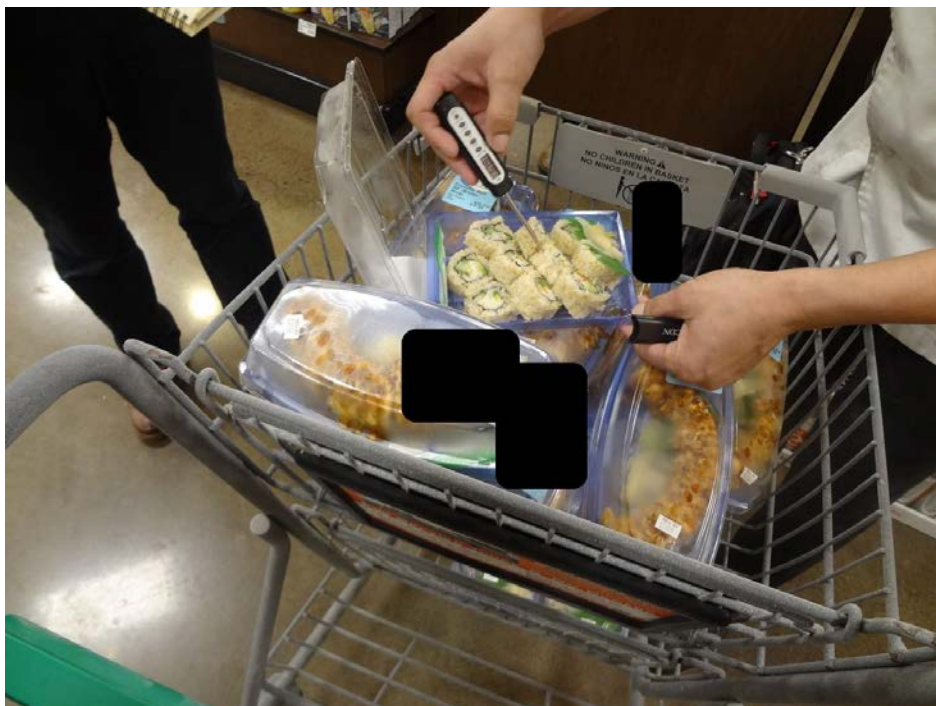
写真 2 2 : 販売冷蔵棚の寿司の温度測定 (測定後パックを閉じてそのまま販売)
