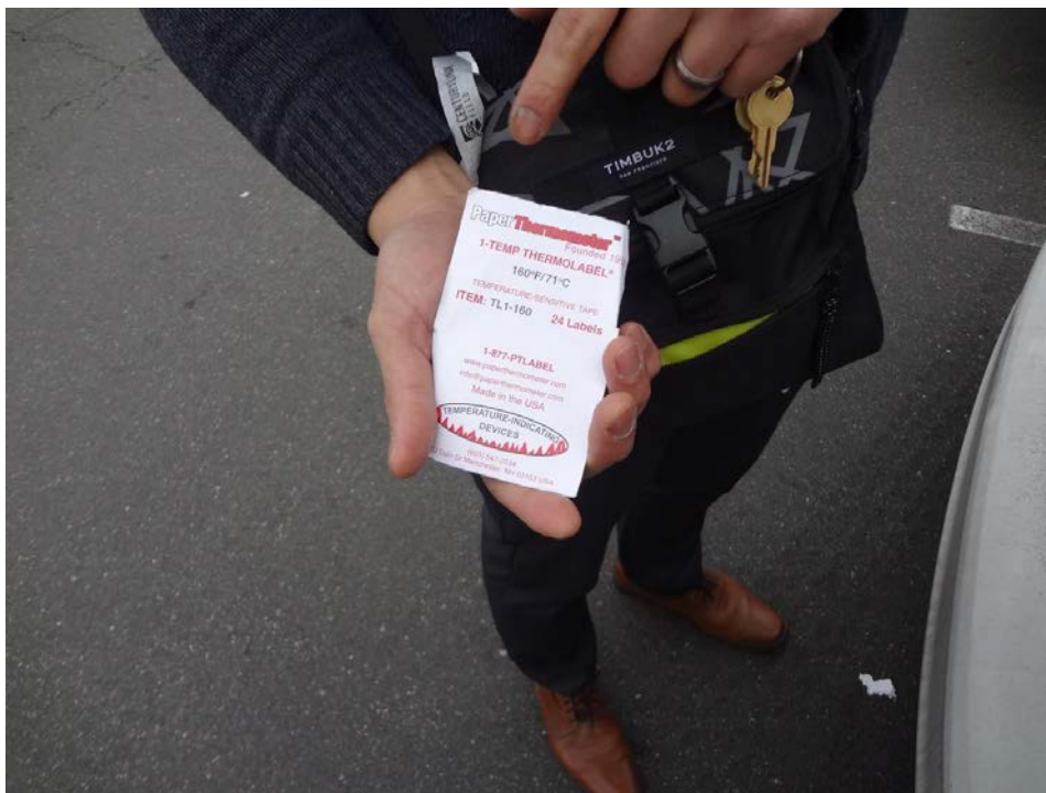
写真2：温度試験紙（食器洗浄器内が規定の高温に達したかを確認する等）
