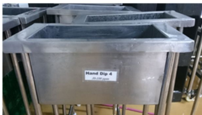
写真2-5 グローブが汚れた時に浸す消毒槽(塩素濃度50-100ppm)
