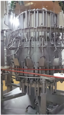
写真2-1 我が国には導入されていないBAYLE社製内臓摘出装置
