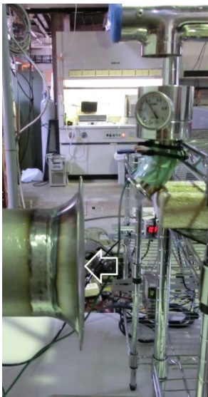
図 2 - 2 パルスジェット式除じん装置（アマノ PiF30）の性能評価のための粉体分散方法（広島大学）
