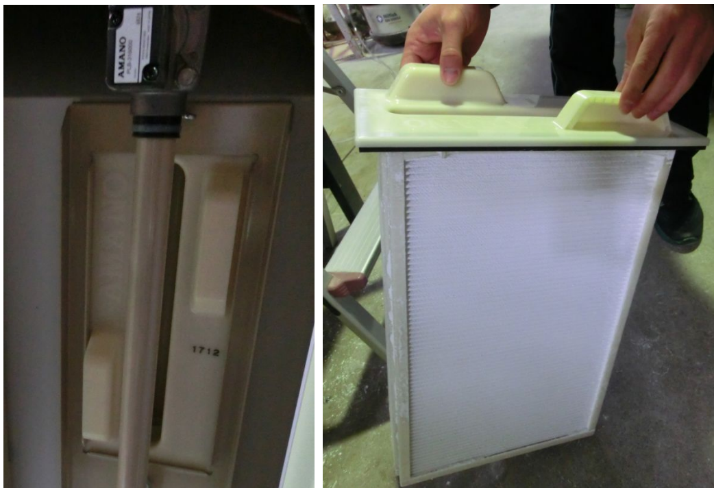
図2 - 4 フィルタの状態 左 装てん状態、 右 取り外した状態
