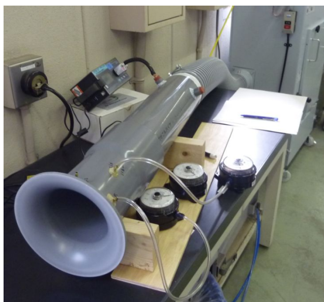
図 3 - 1 2 入口のベルマウスと圧力タップ
