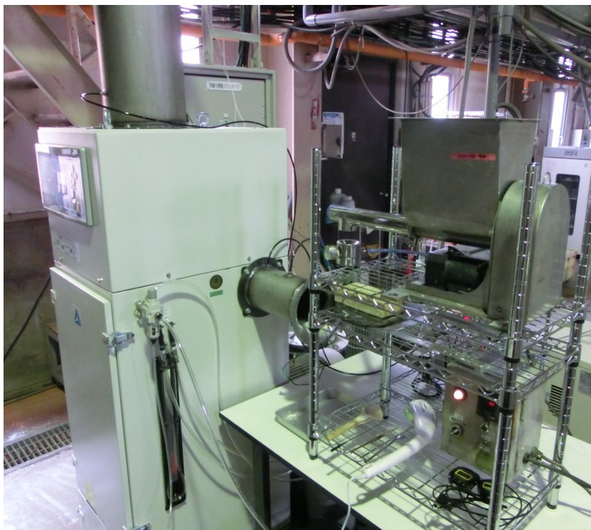
図 2 - 3 パルスジェット式除じん装置の装置構成（広島大学） 左側がパルスジェット式除じん装置で右側が粉じん供給装置 出口濃度は上部（2 階部）に設置してある粉じん計によっている。
