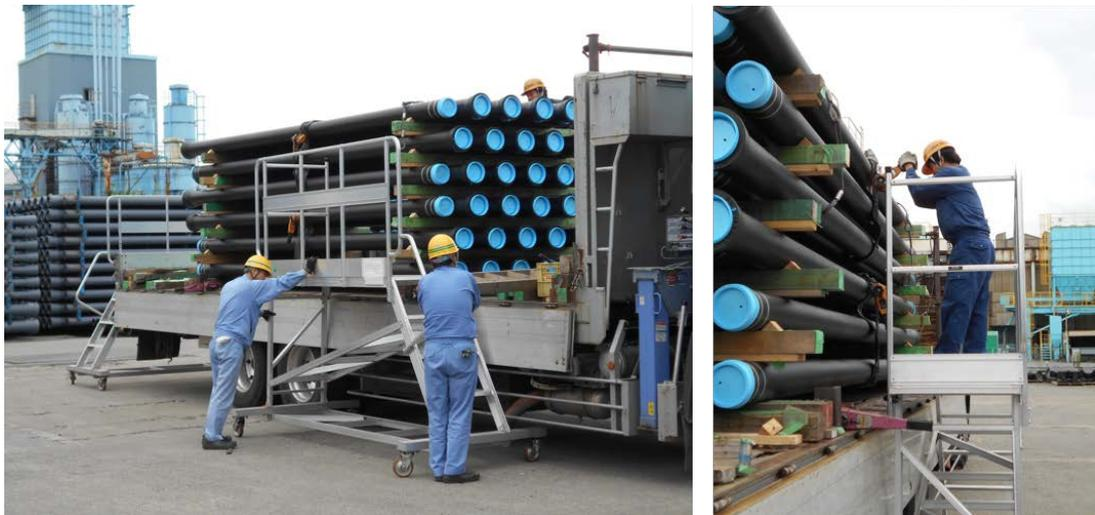
(a) 荷主庭先据置型の墜落防止設備を設置している状況
