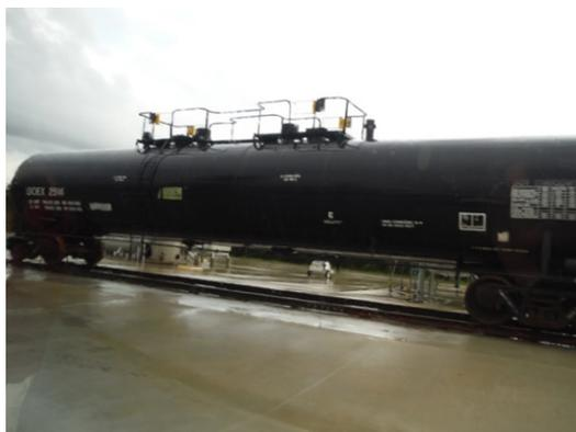
図 2 実物大の化学物質運搬用の貨物車両
