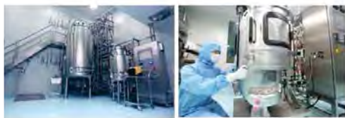
DMBioのプラント (ステンレス2,500L, SUS 2,000L)
