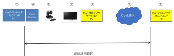
図 4 ディスプレイ信号による遅延計測手法
