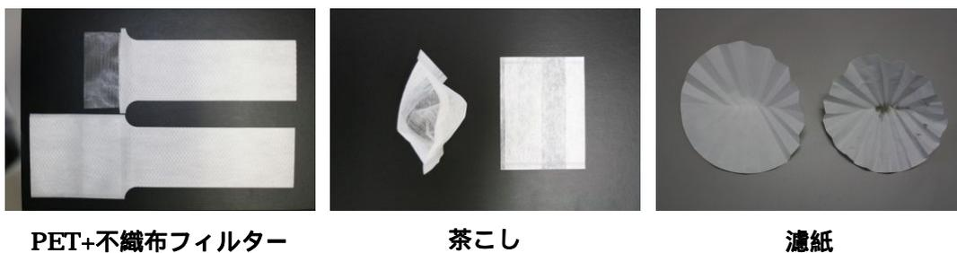
Fig. 4 ダスト捕集フィルター
