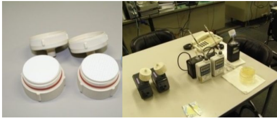
図 2-5-2 MCE フィルター及び測定風景 菌試験管に保管，蒸留水（注射用水；ET フリー）を添加し，ボルテックスミキサーで撹拌した後，上澄み液を分注・分析した。
