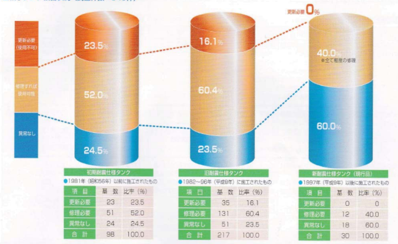
■給水タンク被害状況（調査件数：345件）
