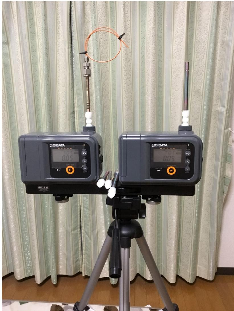
図1 間欠サンプリングポンプの外観
