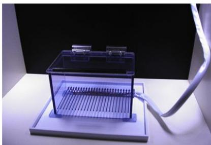
**プレパルス驚愕反応抑制試験**：突発的に大きな音刺激をマウスに呈示したときに生じる驚愕反応（反射：全身の筋肉収縮）による体動を、加速度計や静電気検出器などによって測定する試験。本系においては加速度計による測定を行っている。また、大きな音刺激の数ミリ秒前に比較的小さい音刺激を提示することによって驚愕反応が抑制されること（プレパルス驚愕反応抑制）が知られているが、ヒトの統合失調症において、このプレパルス驚愕反応抑制不全が生じることが多く、統合失調症患者の呈する生理反応の1つとされている。120dB に対して、プレパルスを 90、95、100、105dB 提示した場合の驚愕反応抑制率を評価指標とする。
