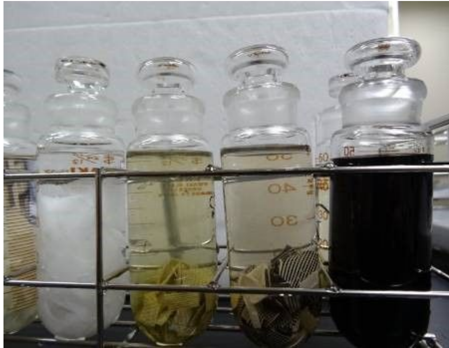
図 6 アセトン超音波抽出後の試料液
