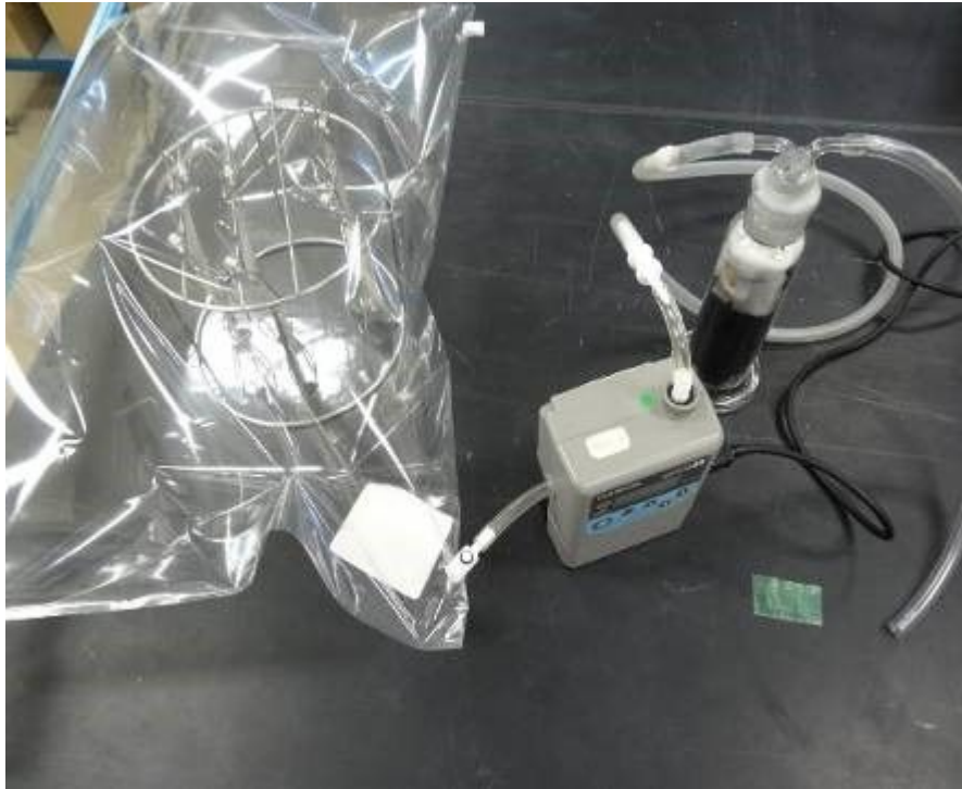
図 11 サンプルバックを用いた放散試験
