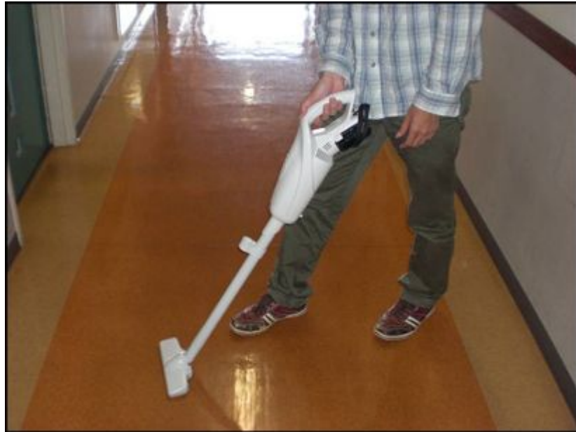
図7 ハンディー掃除機（リョウビ BHC1400）用いたダスト捕集
