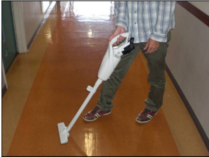
図 5-1 ハンディー掃除機（リョウビ BHC1400）用いたダスト捕集
