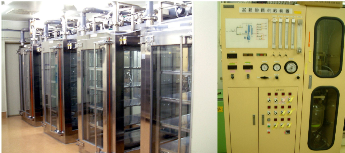
Photo 1 3m 3 横層流大型チャンバー及びその発生装置(柴田科学)
