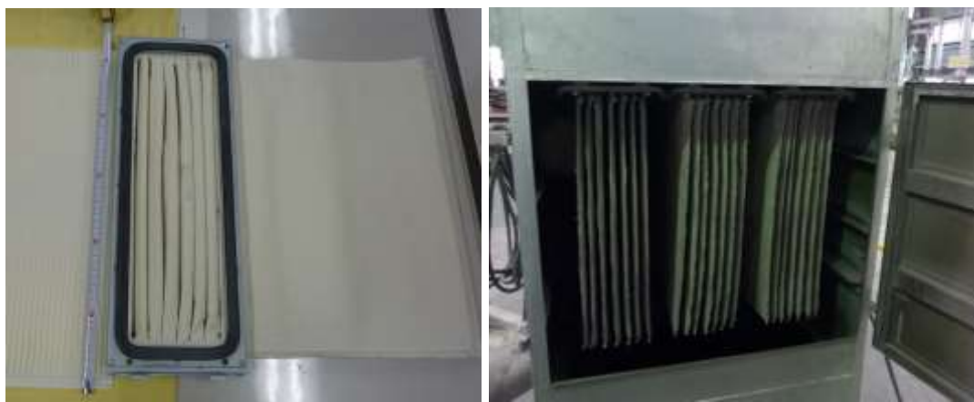
図3-18 ろ布と取り付け金具からなるろ布ユニットと除じん装置に取り付けた状態
