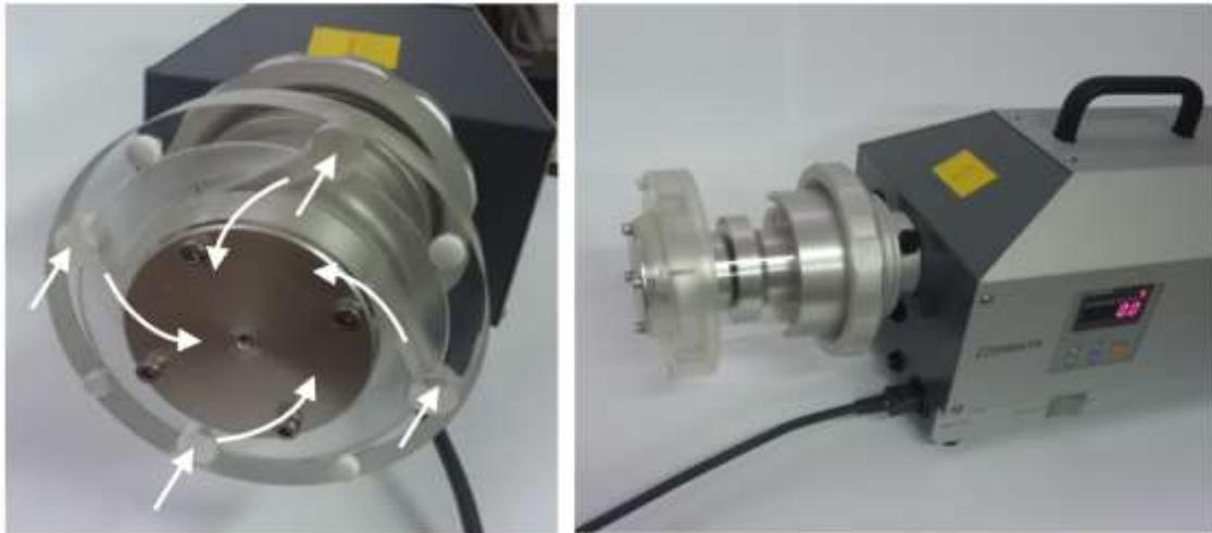
図2-7 ハイポリウムエアサンプラ用のサイクロン 左の図の白の矢印はサンプリング気流の方向を示している。
