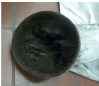
図3-17 集じんろ布に捕集されていた粒子の観察 溶接ヒュームを主とした粒子
