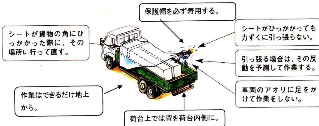
図6．荷のシート掛け作業における基本対策
