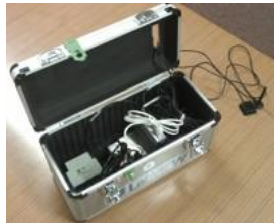
図1 標準的な KURAMA-II の内部。CsI 検出器(浜ホト C12137)と組み込み PC、通信モジュールが 34.5 cm×17.5 cm×19.5 cm のツールボックスに納められている。
