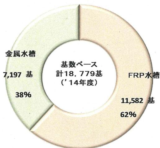
図3. 貯水槽の材質構成比
