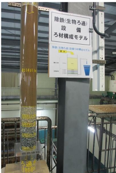
除鉄 ( 生物ろ過 ) 設備ろ材構成モデル
