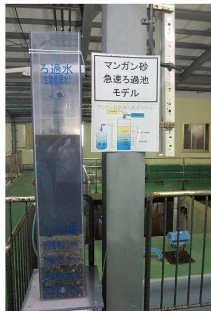
マンガン砂急速ろ過池モデル
