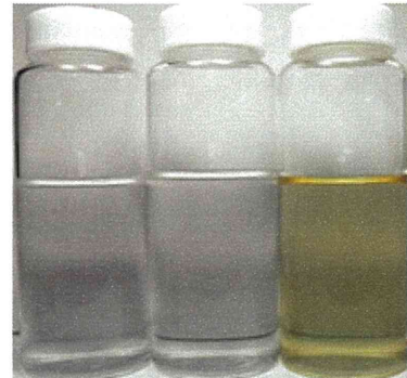
図 3 マンガンイオンを含む地下水を用いたモノクロアミン消毒の事前適合性試験
