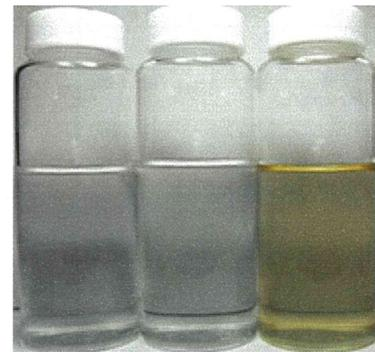
図1 マンガンイオンを含む地下水を用いたモノクロラミン消毒の事前適合性試験
