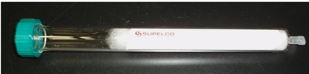
図3 ISO/DIS 16000-33 に従って調整した ISO カラム
