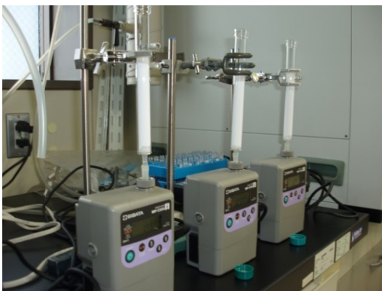
図 14 各種サンプラーを用いた添加回収試験の様子 (流速 2 L/min)
