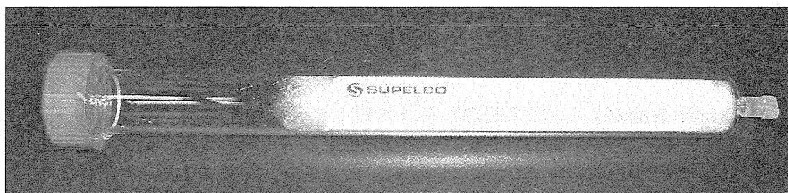
図3 ISO/DIS 16000-33 に従って調整した ISO カラム
