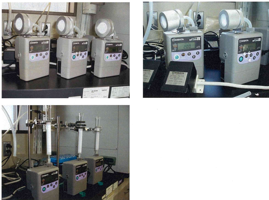
図 14 各種サンプラーを用いた添加回収試験の様子（流速 2 L/min）
