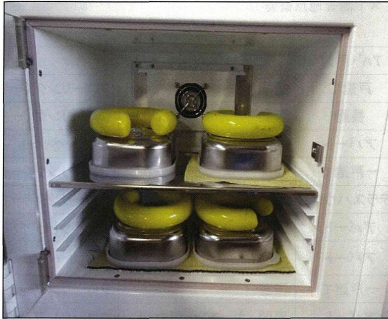
図5 エミッションセルを用いた放散試験
