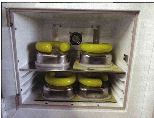
図1 エミッションセルを用いた放散試験
