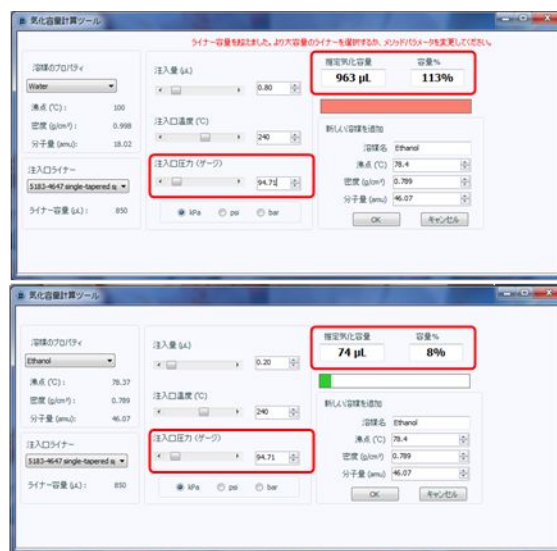
図2 2 公定法のカラム条件における推定気化容量上:水 0.8 \mu\text{L} 、下:エタノール 0.2 \mu\text{L}
