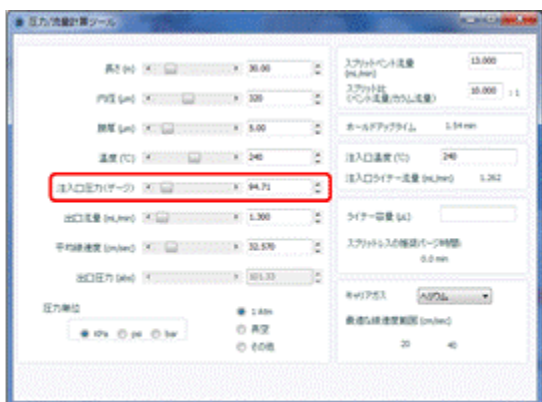
図2-1 公定法のカラム条件における注入口圧力の計算
